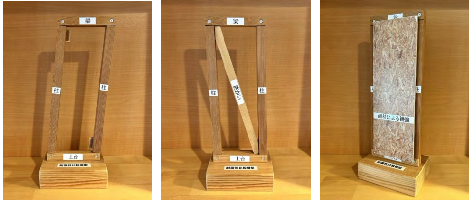
耐震改修では、模型を使用しての説明することで住まい手の理解が深まります。写真は筋交いや梁等、構造を説明する模型 (提供: 安心ホーム計画)
