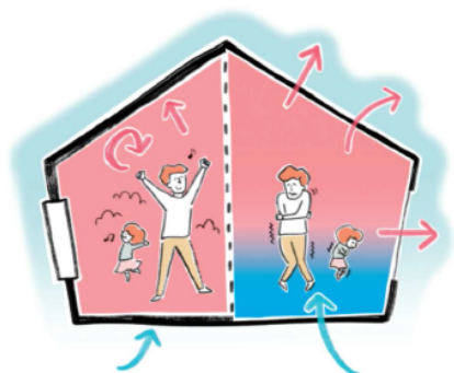
断熱改修後 断熱改修前
