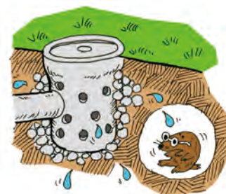
浸透枳による雨水の土壌浸透
