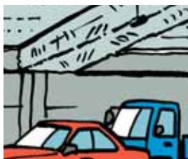
吹付け石綿の例
