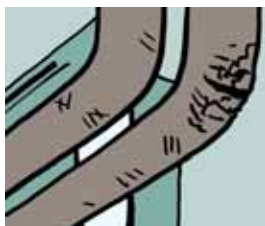
石綿含有保温材の例
