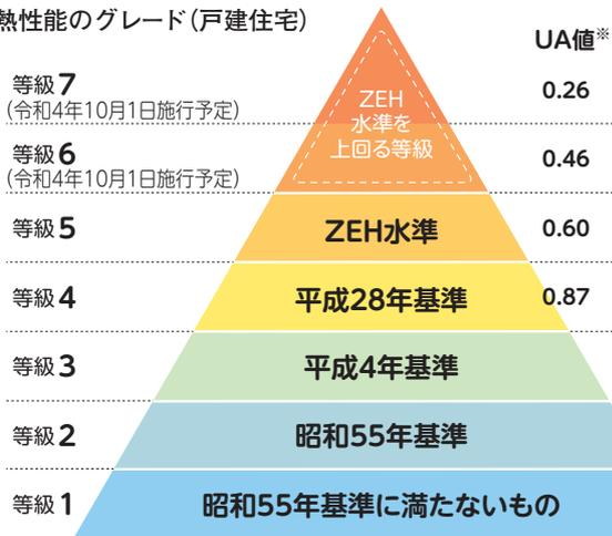
※UA値とは断熱性能の指標で、住宅内部から外皮(床、外壁、屋根(天井)、開口部等)を通過して外部へどれ位熱が逃げているかを数値で表します。数値が小さい程、性能が高くなります。同じ等級でも地域区分により異なり、ここでは6地域について示しています。
