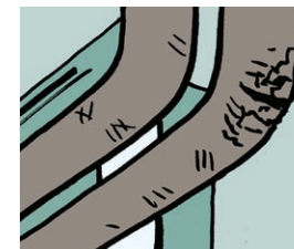
石綿含有保温材の例
